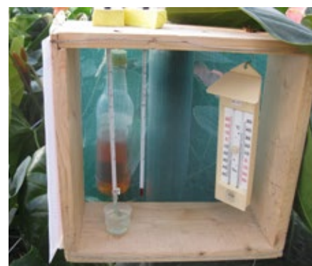
Contatore dell'umidità dell'aria
